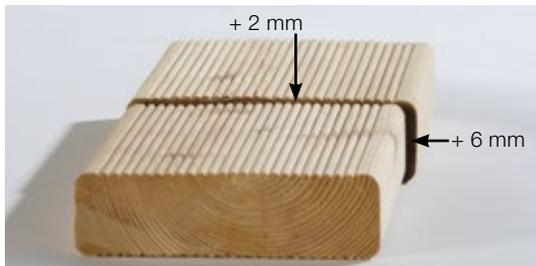
1. Beispielhaft: Gleiches Holz trocken (18%) und nass (hinten).
