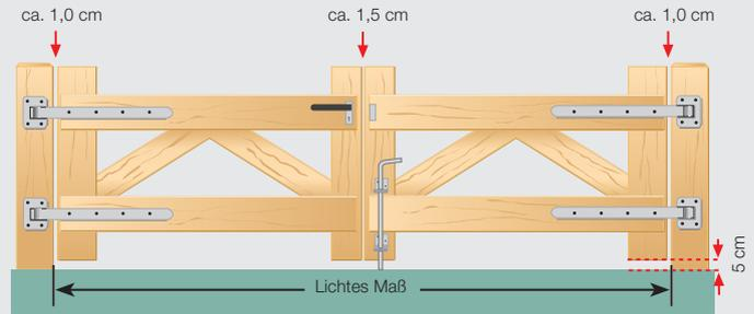
Doppeltore haben in der Regel einen Standflügel (mit Feststeller fixiert) und einen Gehflügel. Bitte geben Sie auch hier DIN-Richtung des Gehflügels an (siehe Text Abb. 5)
