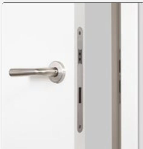
**Vorteil Magnetschloss:** das Schließblech ist bei geschlossener Tür nicht sichtbar, da die Falle erst bei vollständig geschlossener Tür magnetisch verriegelt, ohne dass ein mechanischer Kontakt zum Schließblech nötig ist. Dadurch reduziert sich das Schließgeräusch deutlich.
