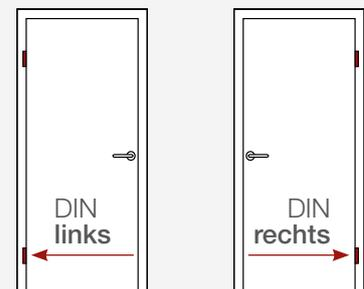
Die DIN Richtung gibt an, in welche Richtung die Tür geöffnet wird. Sie wird von der Türseite aus ermittelt, an welcher sich die Bänder befinden.
