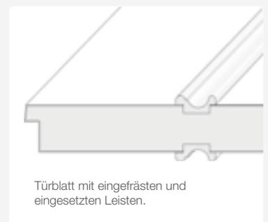
Türblatt mit eingefrästen und eingesetzten Leisten.
