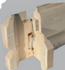
► Die patentierte 6-Plus-Eckverbinding verknüpft die Bohlen mittels Verschraubung. Es ist keine Gewindestange als Wandsicherung nötig und somit entfällt die Wartung dieses Systems.
