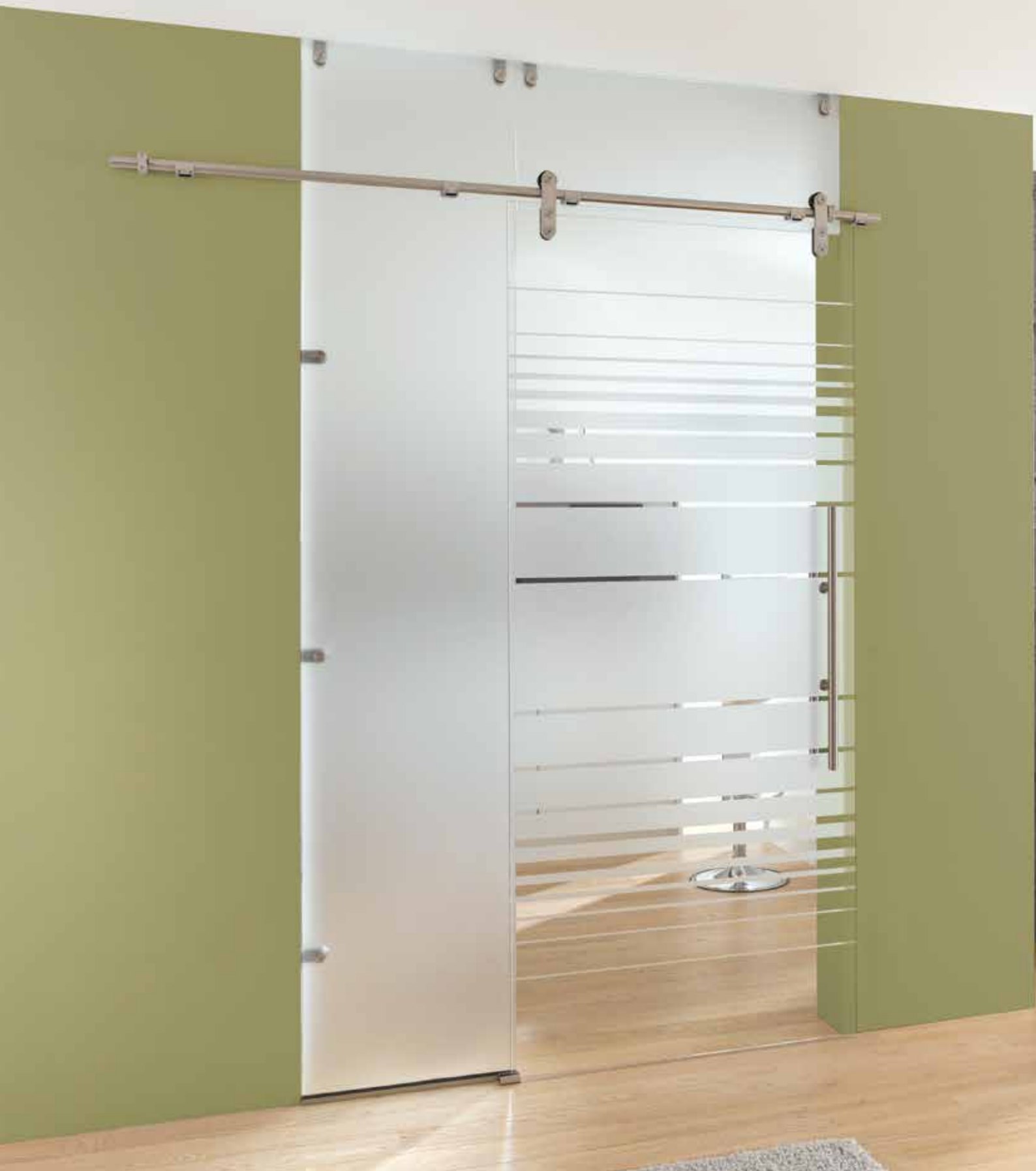
Glasschiebeanlage Typ 1 | Schiebesystem: Edition Basic, Edelstahl matt, Seitenteil und Oberlicht: Satinato | Glasdesign: Struktura Typ 8, Motiv matt/Fläche klar Griffstange: L&H G 700 rund, Edelstahl matt
