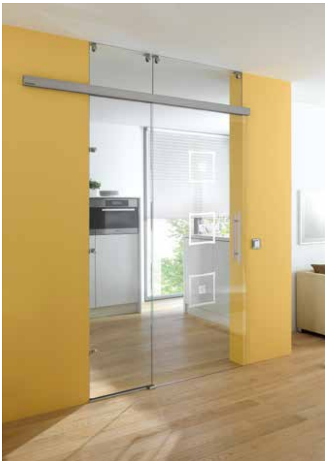
Glasschiebeanlage Typ 1 | Schiebesystem: Tvin 2.0/ 120, ähnl. Edelstahl matt Seitenteil und Oberlicht: Float hell | Glasdesign: Alana, Motiv matt/Fläche klar Griffstange: L&H G 420 rund, Griffleiste einseitig, Edelstahl matt
